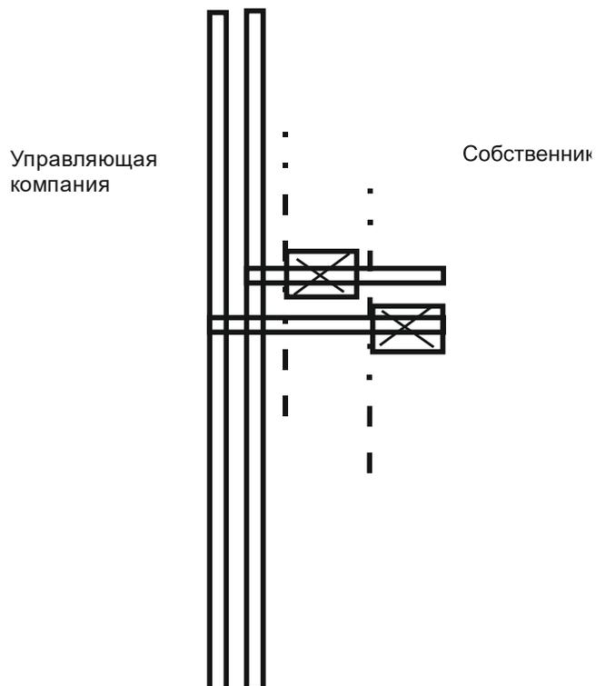
Первые запорно-регулирующие краны на отводах внутриквартирной разводки от транзитного стояка горячего и холодного водоснабжения. Транзитный стояк обслуживание Управляющая компания, систему после точки разделения от первого вентиля на стояке – Собственник.
