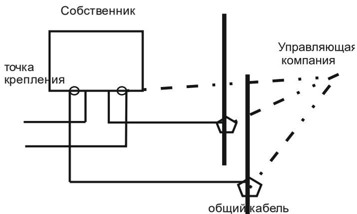
Стояковую разводку (общий кабель) и точки крепления провода обслуживает Управляющая компания. От точек крепления отходящих к помещению Собственника фазового, нулевого и заземляющего проводов от вводного выключателя и всё электрооборудование обслуживает – Собственник.
