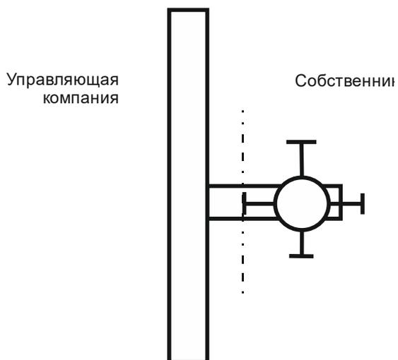
Точка присоединения отводящего трубопровода системы водоотведения к тройнику транзитного стояка общедомовой системы водоотведения. Сам стояк обслуживает Управляющая компания, тройник и остающуюся часть – Собственник.
