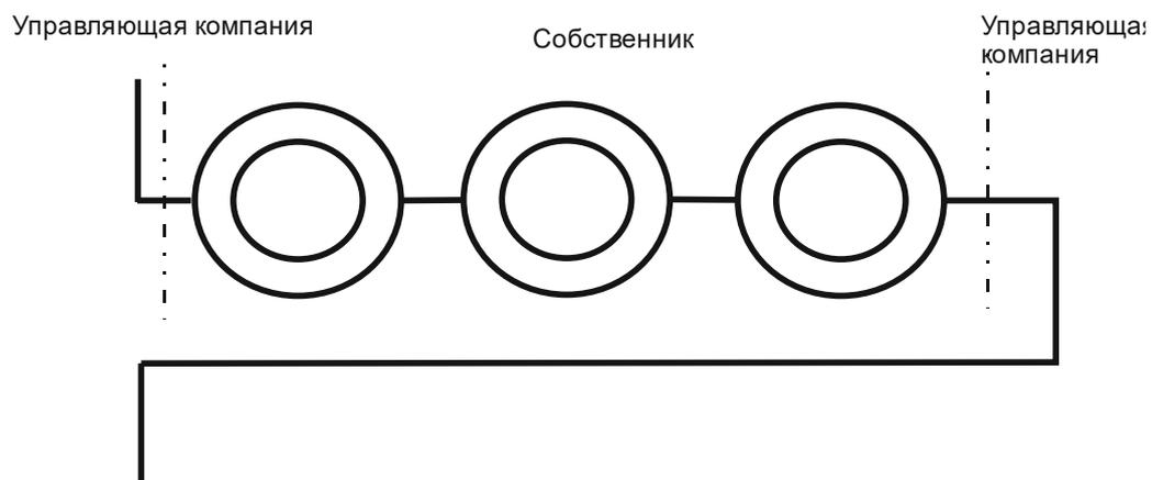
Подводку к первому квартирному датчику ОПС и АППЗ обслуживает Управляющая компания, остальное, включая автономные извещатели, обслуживает Собственник.
