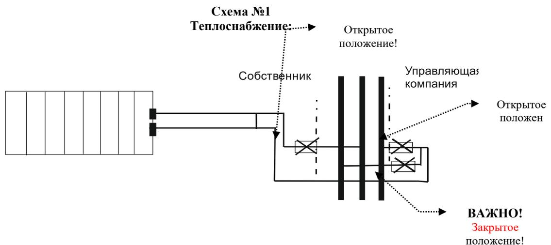
Первые точки присоединения подводящих и отводящих трубопроводов системы отопления. Подводящие и отводящие трубопроводы до точек присоединения обслуживает Управляющая компания, остающаяся часть – Собственник.
