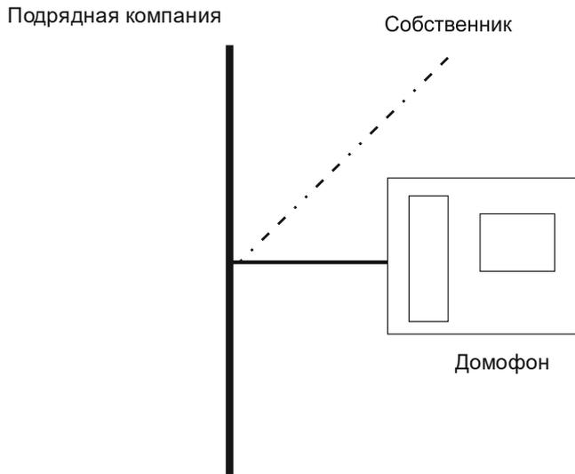
Точка присоединения квартирного кабеля к общедомовому кабелю. Разводку кабелю по дому обслуживает Подрядная компания, остальное – Собственник.
